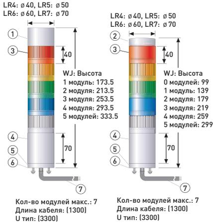
**Монтаж А [WJ] Прямой монтаж/Кабель (M2: AC100В - 240В)**
